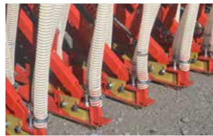
Enkel justering/bytte av kniver
